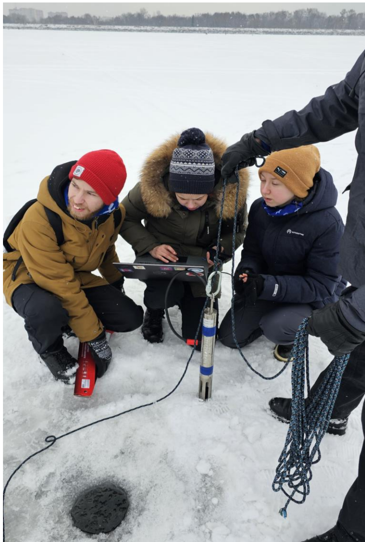
Подлёдные измерения вертикальных профилей гидрофизических параметров с помощью CTD
