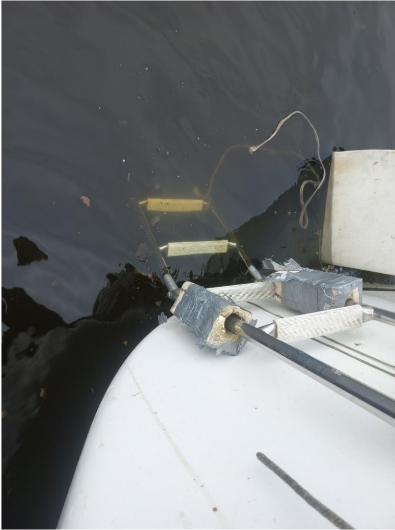
Установленный на судне эхолот для измерения глубины
